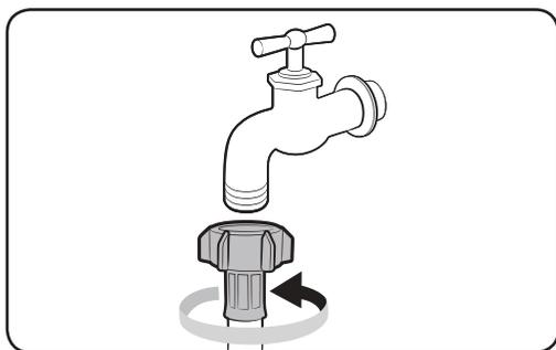
7. Если у вас установлен водопроводный кран винтового типа, воспользуйтесь прилагаемым адаптером винтового типа для подключения к водопроводному крану, как показано на рисунке.
