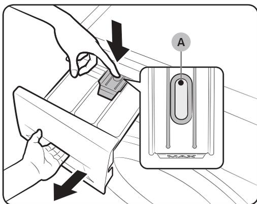
1. Нажмите **освобождающий рычаг (A)**, расположенный внутри ящичка для моющих средств, и извлеките ящичек.
